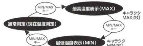
最高温度(MAX)メモリ及び最低温度(MIN)メモリはON/OFFキーを押して本器の電源が入ってからの温度測定値をメモリします。ON/OFFキーを押して本器の電源を切ると、最高温度(MAX)及び最低温度(MIN)メモリはクリアされます。
