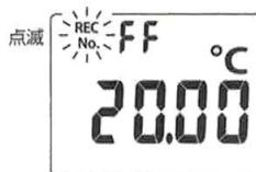
REC モード時に REC キーを押し続けると約 1 秒間隔で温度値を連続記録(連続 REC 機能)することができます。
